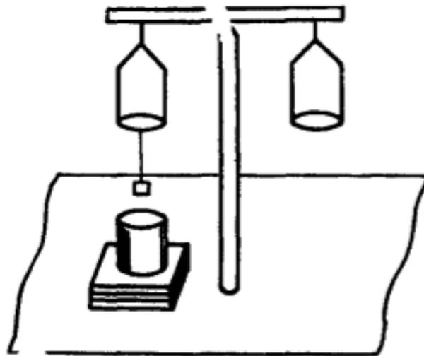
Определяют массу образца в воздухе ( $m_1$ ), накалывают на иглу образец, опускают его в стакан с водой, уравнивают весы с образцом, погруженным в воду, и определяют массу уравновешенного груза ( $m_2$ ). При уравнивании образец должен находиться ниже уровня воды приблизительно на 10 мм и не касаться стенок и дна стакана.
