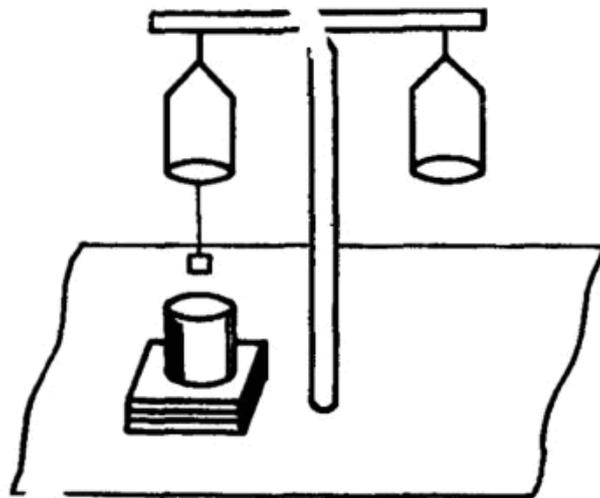
Определяют массу образца в воздухе ( $m_1$ ), накалывают на иглу образец, опускают его в стакан с водой, уравнивают весы с образцом, погруженным в воду, и определяют массу уравновешенного груза ( $m_2$ ). При уравнивании образец должен находиться ниже уровня воды приблизительно на 10 мм и не касаться стенок и дна стакана.
