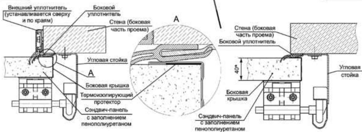
Рисунок Д.3 — Сечение секционных ворот (3D)
