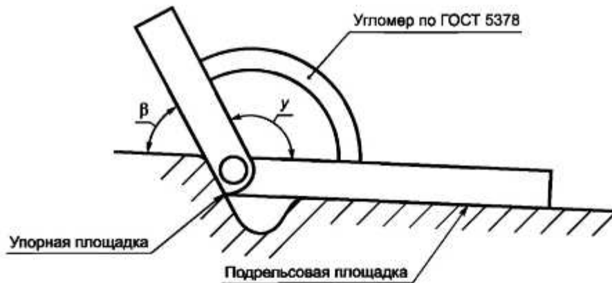
Рисунок 13 — Схема контроля угла \beta наклона упорной плоскости к подрельсовой площадке
