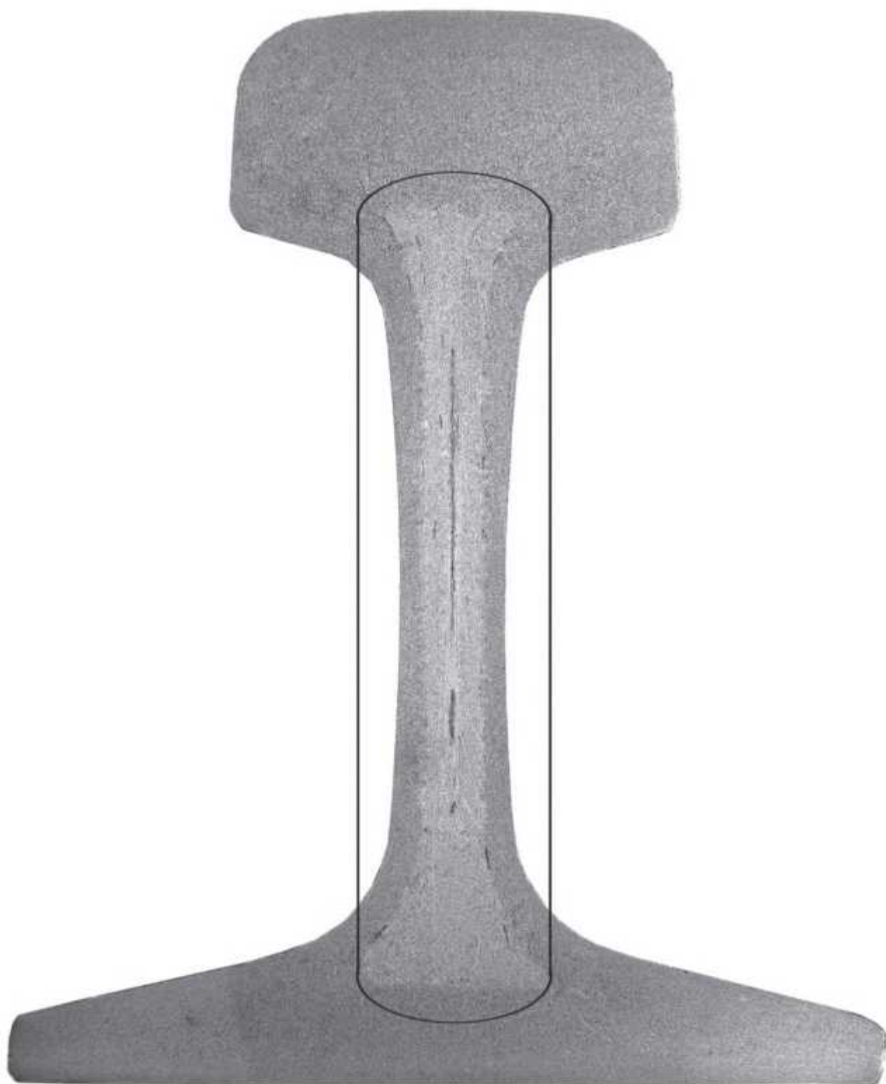
Рисунок И.7 — Ликвационная зона, имеющая ширину, превышающую 1/3 толщины шейки (глубокое травление)
