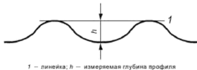
Рисунок А.1 — Измерение глубины профиля h для черепицы с волнистым профилем
