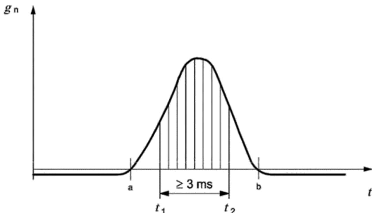
$a$  – точка начала измерения удара,  $b$  – точка окончания измерения удара
