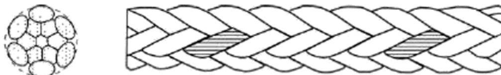
Рисунок 2 — Конфигурация 12-рядного плетеного каната (тип T)
